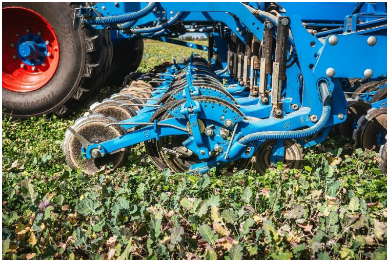
Image 2 : Le soc de semoir ProDisc permet un positionnement précis lors des techniques simplifiées.
